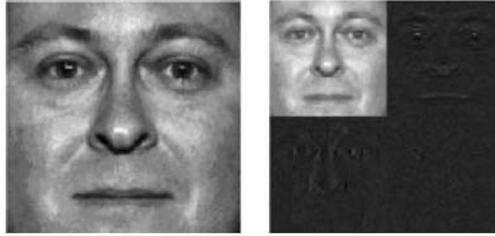
**Fig. 12.** Izquierda: imagen original; Derecha: descomposición de ondas de primer nivel.
