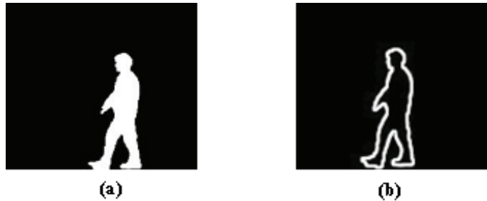
Fig. 6. (a) imagen segmentada (silueta), (b) detección del borde (contorno de la silueta) [22]
