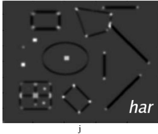
**Fig. 10.** Método de Harris paso a paso. (a) Figura original. (b) y (c) derivadas de la imagen en las direcciones  $x$  y  $y$  respectivamente. (d) - (f) componentes de la matriz de autocorrelación. (g) - (i) desenfoco gaussiano sobre los componentes de la matriz de autocorrelación. (j) Imagen resultante con las esquinas resaltadas
